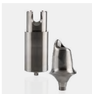
Pièce brute pour pilier en titane et pilier en titane usiné selon le processus TI-Forms
