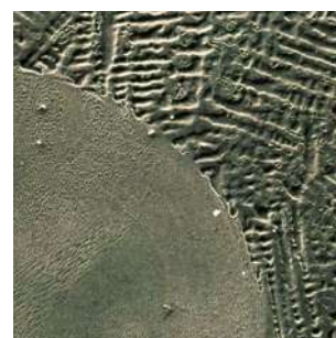
Cordon de soudure laser sans fissures (alliage de coulée CoCrMo sans carbone)
