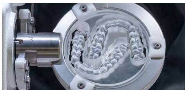
Réalisation facile et reproductible de gouttières avec Ceramill CFAO
