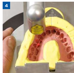
4 Positionner le trou de forage à l'aide du point de laser, et déclencher l'opération de forage
