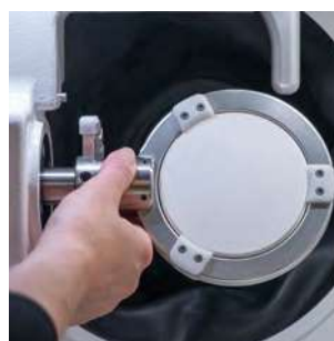
Changement aisé du support de pièces brutes pour passer du fraisage au meulage
