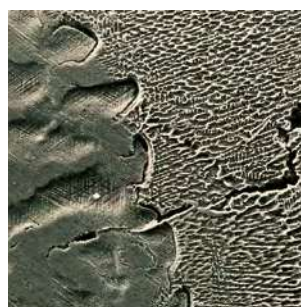
Fissures provoquées par les carbures (alliages de coulée CoCrMo contenant du carbone)
