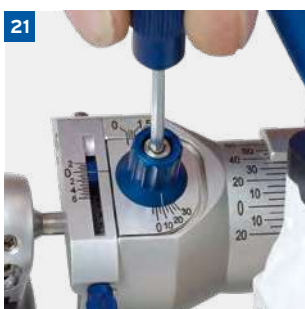
Ouverture de la vis de réglage de l'ISS. Remonter la tige incisale
