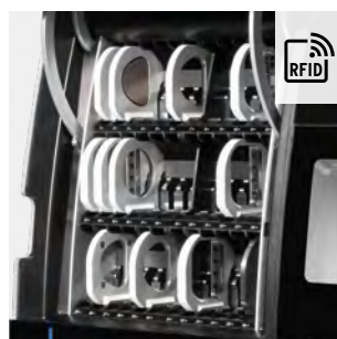
Réservoir de pièces brutes intégré et contrôlé par RFID
