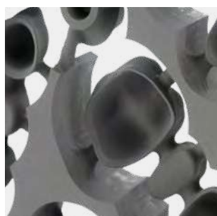
Ceramill Sintron fraisé - unités avant le frittage
