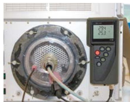
Klimaschrankprüfungen Quality control of climatic cabinets
