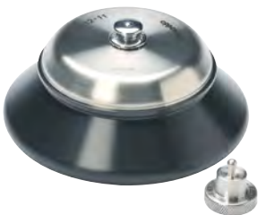
Rotor F-45-12-11 > pour 12 tubes de 1,5/2,0 mL
