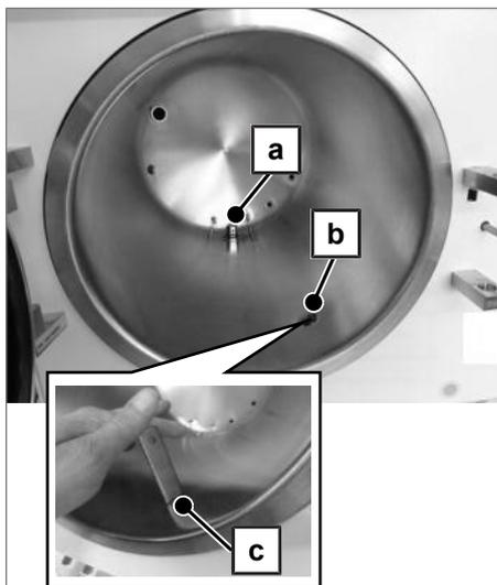
2. Pour le nettoyage, rincez les filtres (pos. a et b) avec de l'eau.
