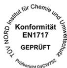
La pose de cet autocollant permet au constructeur de l'appareil d'indiquer la conformité du dispositif médical à la norme Européenne EN 1717 (Protection contre la pollution de l'eau potable dans les réseaux intérieurs et exigences générales des dispositifs de protection contre la pollution par retour).
