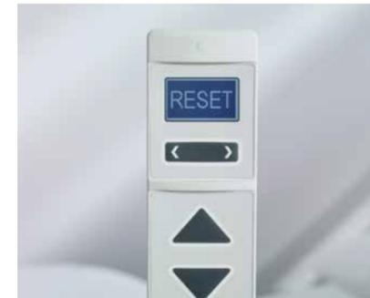
▼ LCD-Handschalter kann während des Transports sicher in die Aufnahme eingesteckt werden und ist so vor Beschädigungen geschützt.
