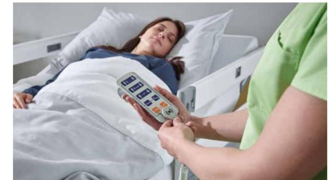
▲ Notfallverstellungen können nur mit einem Magneten freigeschaltet werden, sodass der Patient niemals Zugang zur Pflegeebene bekommt.
