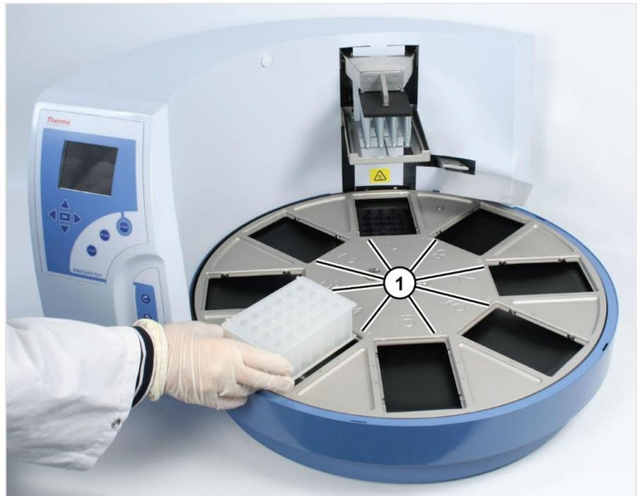
Figure 41. Load the tip-plate
