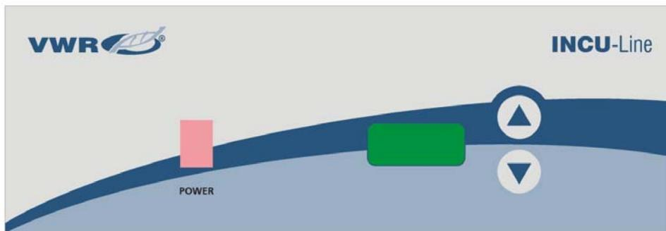
POWER - interruptor de alimentação: Para fazer com que a incubadora ON e OFF. A tecla de alimentação ilumina-se quando a incubadora está LIGADA.
