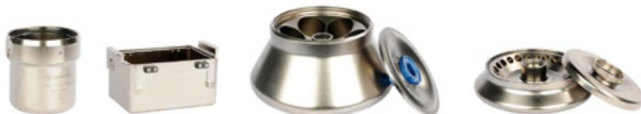
Sigma propose pour tous les godets et rotors en aluminium un revêtement pour salles blanches extrêmement résistant. Ce revêtement offre une protection fiable contre la corrosion des accessoires, notamment dans les environnements où des agents chimiques
