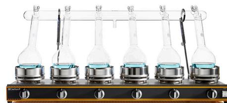
« Les chauffages individuels, rampes chauffantes et chauffages de ballons C. Gerhardt font partie de l'équipement standard dans de nombreux laboratoires. »
